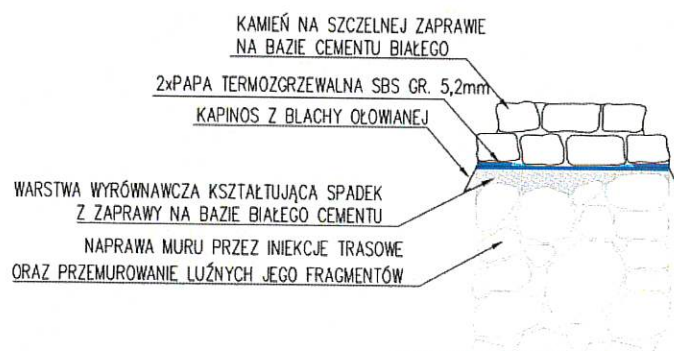
Rys. 13 Przekrój przez zabezpieczenie dolomitom z warstwą izolacji
