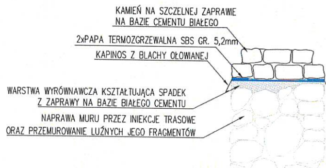
Rys. 10 Przekrój przez zabezpieczenie kwarcytem z warstwą izolacji
